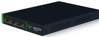
单用户模拟器支持802.11a/b/g/n/ac/ax等多种制式，可进行AP/Station的模拟，支持所有MAC层和物理层参数配置。内置了操作系统和iPerf流量测试工具，无需打流PC即可完成流量数据的生成。即可作为自动化测试系统中的仪表也可以独立用于终端的快速性能检测与验证。
